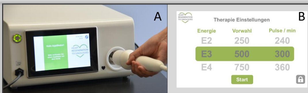
Abbildung 5: NRG-HeaRT Gerät (A) und Ausschnitt des Touch Screens zur Einstellung der notwendigen Parameter (B).
